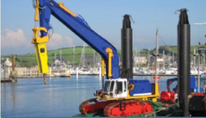
Exemple de brise roche monté sur ponton
