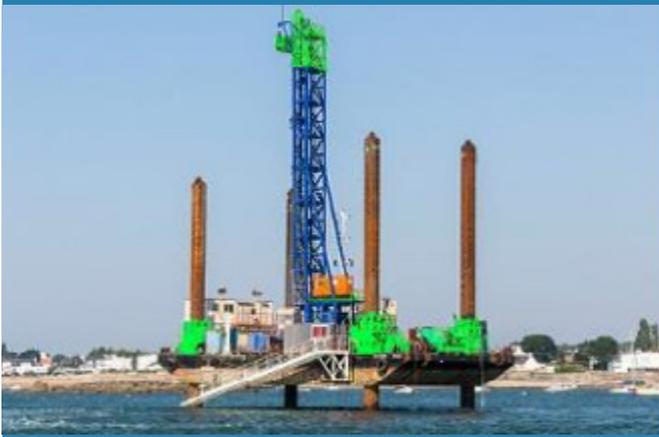
Exemple de tour de forage permettant la pose de charge explosive
